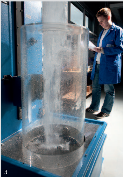
Abb. 3 + 4: Bei der IP x6 Prüfung wird der Prüfling drei Minuten einem Volumenstrom von 100 l/min ausgesetzt.
