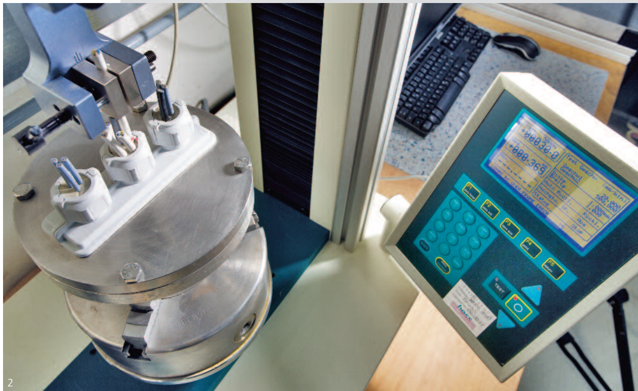
Abb. 2: Prüfung der Zugentlastung im PFLITSCH Prüflabor.
