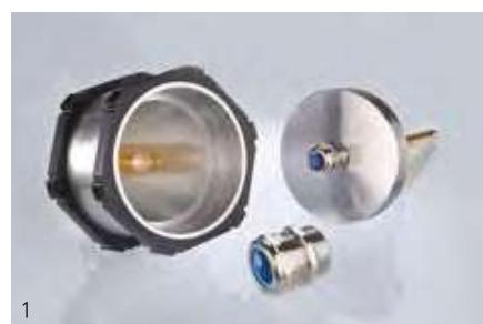
Abb. 1 – KoKeT – Messvorrichtung für die Schirmwirkung von EMV-Kabelverschraubungen
