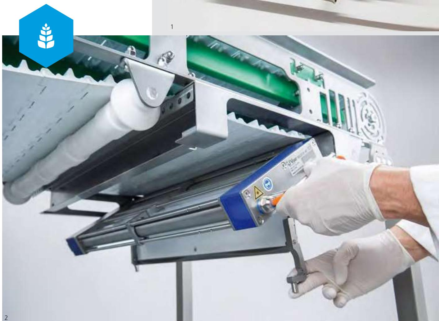
Abb. 1 –blueglobe CLEAN Plus und Blindstopfen CLEAN Plus an einem Bandentkeimer
