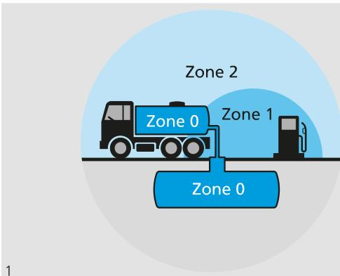
Gasexplosionsgefährdete Bereiche (Zonen) werden nach der Häufigkeit des Auftretens und der Dauer des Vorhandenseins einer explosionsfähigen Gasatmosphäre aufgeteilt.
