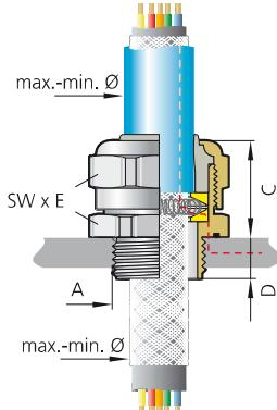
Abb. 3 – Variante A: abgesetzter Außenmantel
