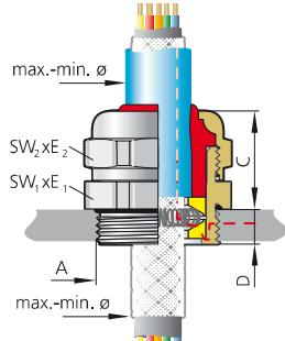
Abb. 3 – Variante A: abgesetzter Außenmantel
