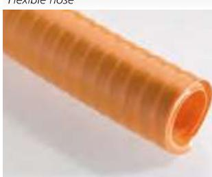
**Polyurethan, doppelwandig (mit leicht gewellter Innen- und Außenwand), formstabil durch eine Hart-PVC-Federspirale (kein Knicken), hochflexibel durch spezielles Luftkammersystem
