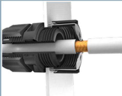
Führen Sie das Kabel durch die Verschraubung und die MagikNUT®, stoppen Sie, wenn die Abschirmung den Metallteil der MagikNUT® berührt.
